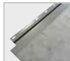
Protihluková vrstva SoundControl je volitelná úprava spodní strany krytiny Click omezující vibrace (resp. hlučnost) neprofilované plochy lamely. Aplikováno ve výrobě, dodáváno jako součást lamely.
